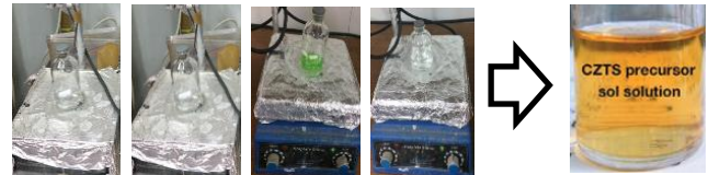
Gambar 04. Proses pengadukan larutan menggunakan magnetc stirrer
