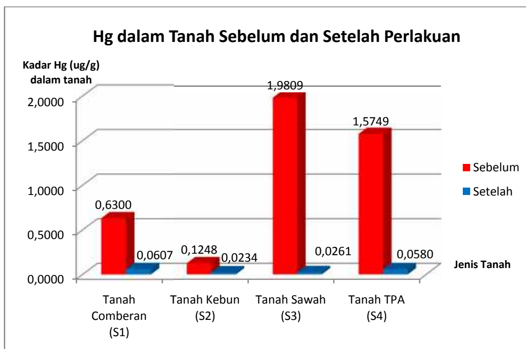
Gambar 1. Kandungan Merkuri (Hg) pada empat macam sumber tanah sebelum dan setelah fitoremediasi menggunakan Celosia plumosa (Voss) Burv. selama 6 minggu.
